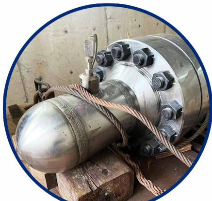
水压实验 Hydraulic test
